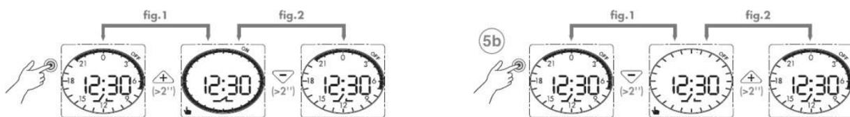
5b Den Joystick eindrücken, um das Display zu aktivieren. Den Joystick für 2 Sekunden in die -Richtung drücken, um manuell AUS zu aktivieren (Abb. 1). Zum Deaktivieren wird der Joystick für 2 Sekunden in die +Richtung gedrückt (Abb. 2).
