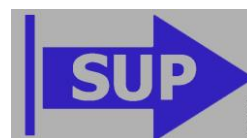
Toevoer naar ruimte ( SUPply Air )
