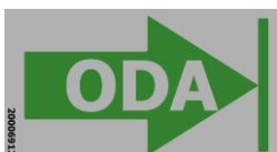
Buitenlucht aanzuig ( Out Door Air )
